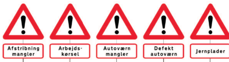
Figur 6.3. Eksempler på A 99 med undertavle ved vejarbejde
