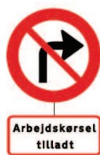
Figur 3.26. Eksempel på C 11 med undertavle som forbyder indkørsel til arbejdsområdet
