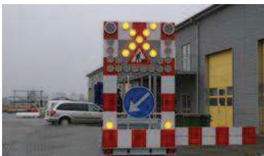
Figur 6.41. Eksempel på afspærringsvogn med sideforskydelig bom (skydebom).
