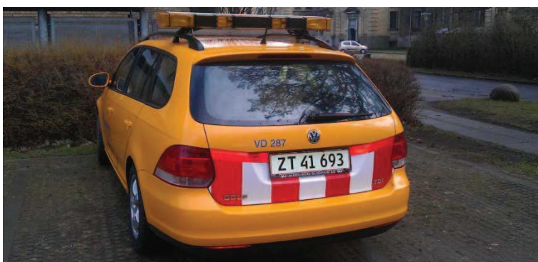
Figur 6.69. Eksempel på afmærkning af tilsynskøretøj med lygtebro og spærrebom
