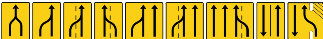
Figur 6.10. Eksempler på E 16 Vognbaneforløb som midlertidig tavle
